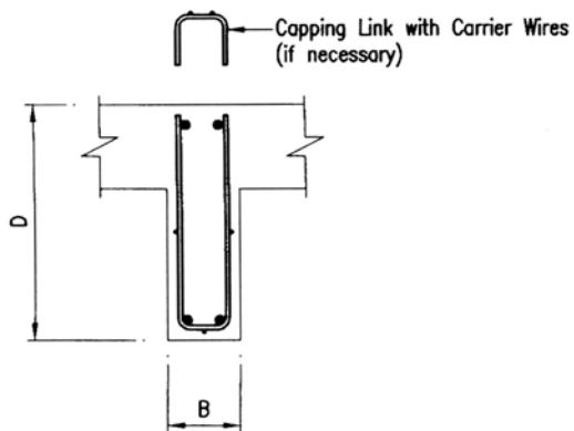
Example '2' (For  $200\text{mm} < B < 400\text{mm}$ )
