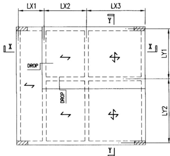
TYPICAL LAYOUT PLAN FOR ONE-WAY & TWO-WAY SLAB
