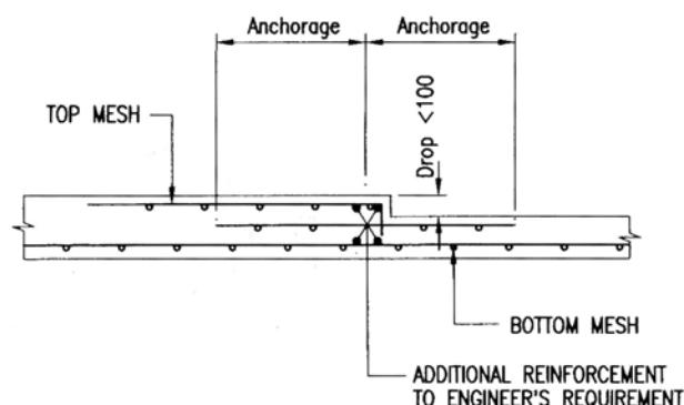
TYPICAL DETAIL OF DROP AT SLAB
