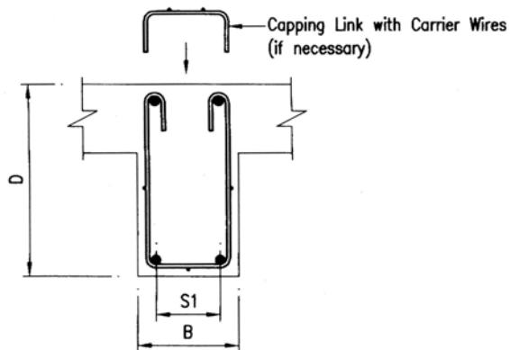
Example '3' (For  $400\text{mm} < B < 600\text{mm}$ )
