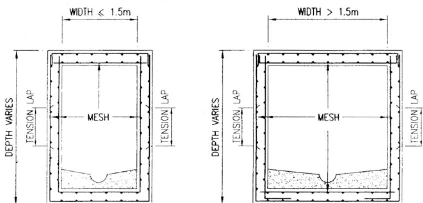
TYPICAL SECTION OF BOX CULVERT
