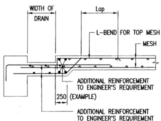
TYPICAL SCUPPER DRAIN DETAIL
